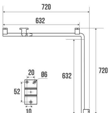
Tube elliptique 38x25 mm en aluminium époxy blanc. Angle 90°. Symétrique.
