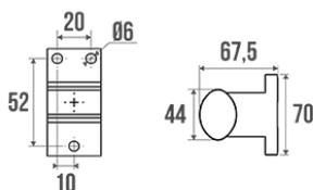
Tube elliptique en aluminium anodisé 38 x 25 mm. Cache-fixations en résine de synthèse chromés.
