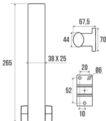
Tube elliptique en aluminium anodisé 38 x 25 mm. Cache-fixations en résine de synthèse chromés.
