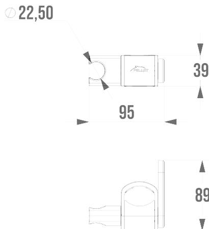
A monter sur les barres ErgoLife en nylon ou les barres droites Arsis en aluminium, 38 x 25 mm.
