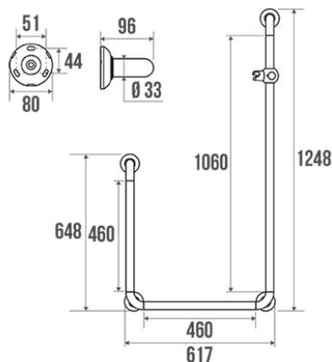
Multicomposants : résine de synthèse blanc + profil aluminium. Tube Ø 33 mm.
