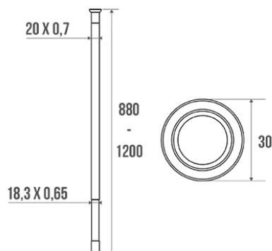
Tube 20 x 0,7 mm. Avec platines, vis et chevilles de fixation.
